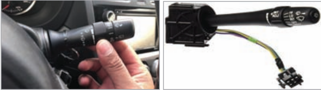
شكل (5): تحديد مكان تركيب المفتاح، وإجراء الصيانة اللازمة
