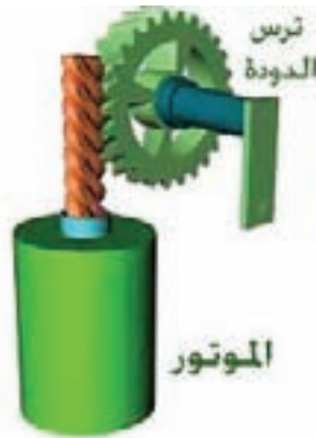
شكل (1): المحرك الكهربائي مع الترس
