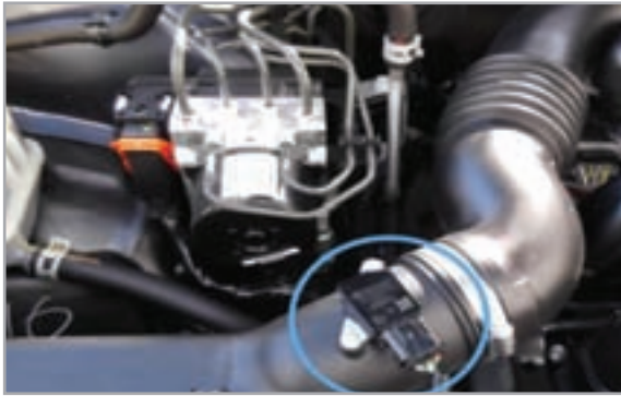
شكل (13): مكان تركيب مجسّ كتلة الهواء
