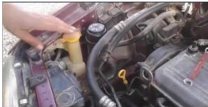
شكل (2): مكان تركيب قربة ماء المساحات مع محرك الرشّ
