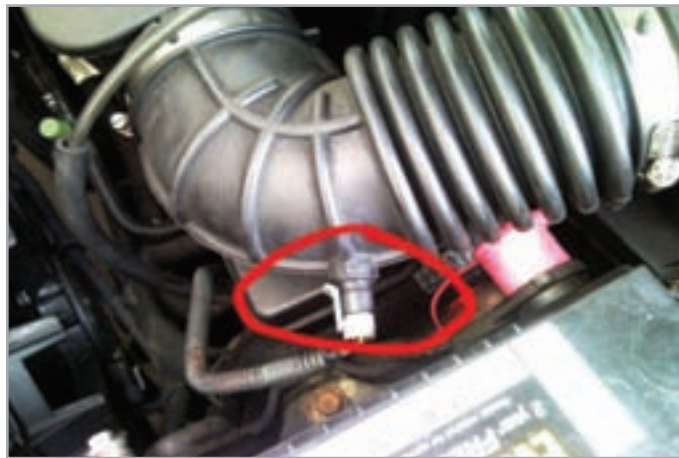
شكل (4): مكان تركيب مجسّ حرارة الهواء
