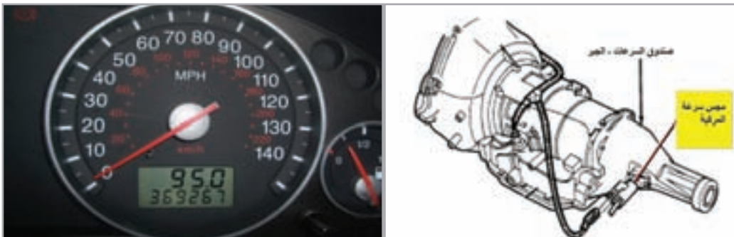
الشكل (9): مجسّ سرعة المركبة، ومبين السرعة
