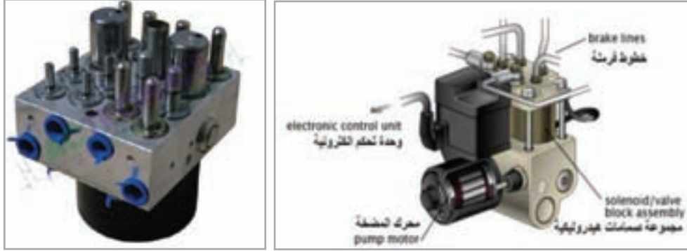
شكل (8): وحدة التحكم في الضغط الهيدروليكي لنظام (ABS)
