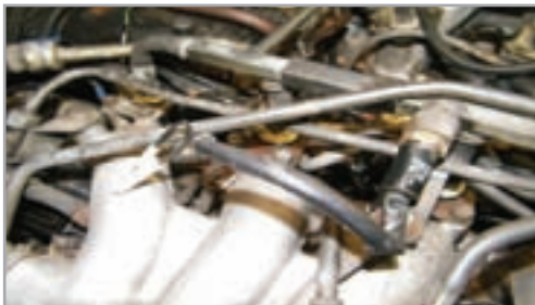
شكل (11): مجسّ درجة حرارة الوقود
