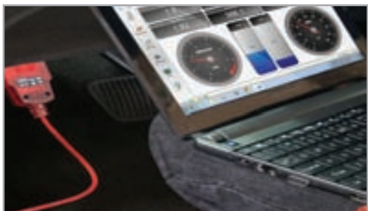
شكل (2): أوصل جهاز الفحص مع المركبة
