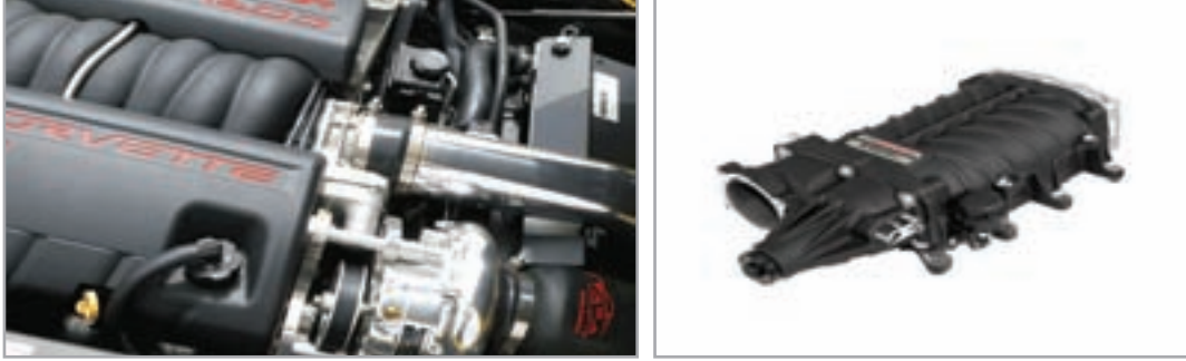
شكل (13): شاحن الهواء ذو الضغط العالي فائق السرعة (سوبر شارجر)
