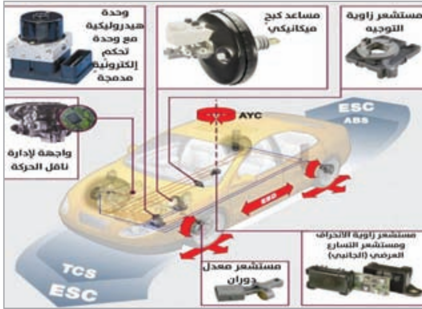
شكل (21): أجزاء نظام الاتزان الإلكتروني (ESP)
