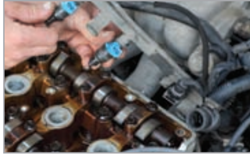
شكل (1): بعض المنفّذات لمنظومة إدارة المحرّك
