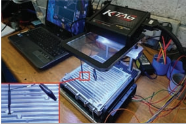
شكل (13): توصيل خارجي لوحدة التحكم مع جهاز البرمجة
