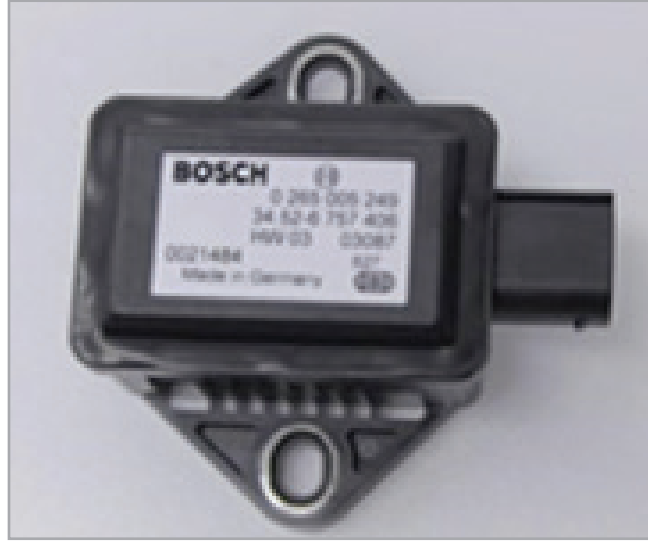
شكل (25): مجسّ التسارع الجانبي (Lateral Acceleration Sensor)
