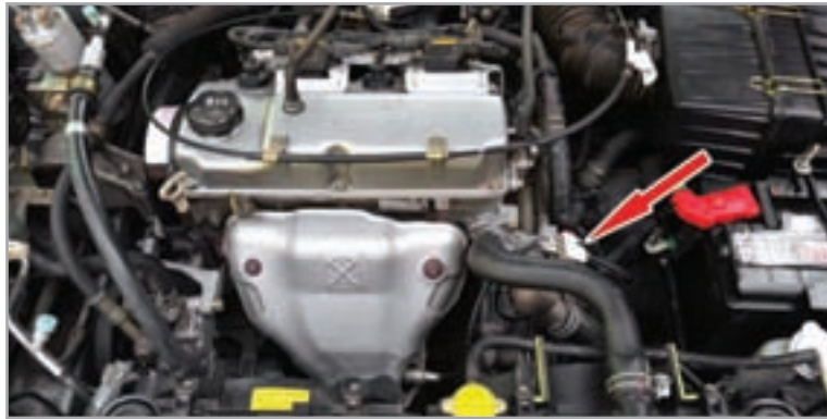
شكل (7): مكان تركيب مجسّ حرارة المحرّك
