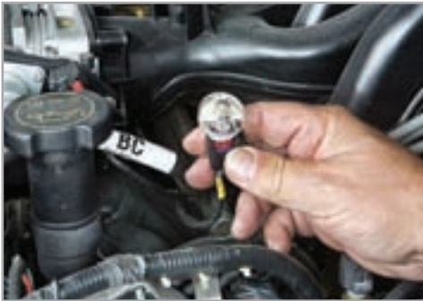
شكل (6): استخدام لمبة LED في فحص إشارة صمام الحقن
