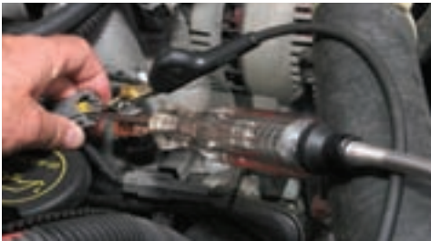
شكل (5): فحص إشارة تشغيل صمام الحقن
