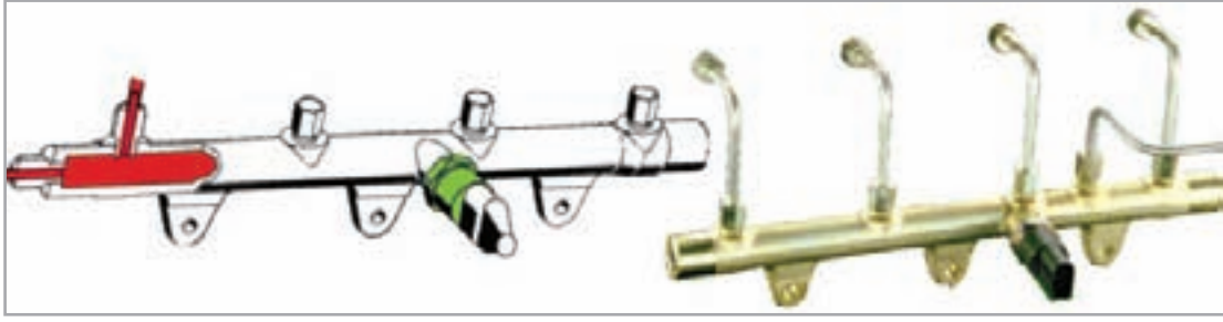
شكل (9): ماسورة التجميع ومجسّ قياس الضغط
