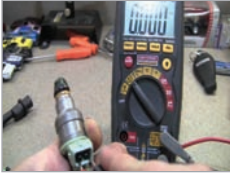
شكل (4): قياس مقاومة صمام الحقن
