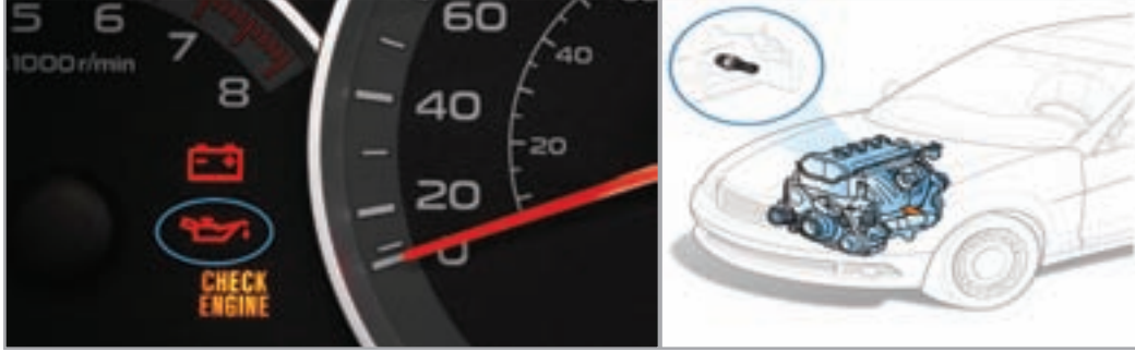
الشكل (3): لمبة تحذير ضغط الزيت، ومجسّ ضغط الزيت
