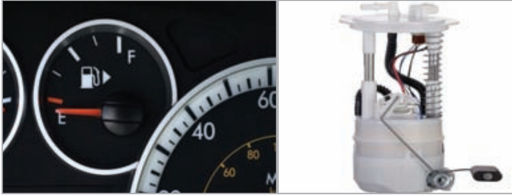
الشكل (8): عوامة الوقود، ومبين مستوى الوقود
