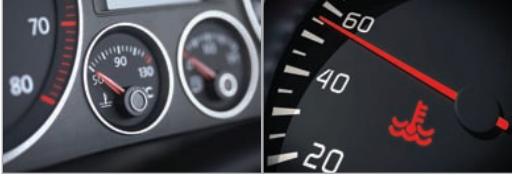
الشكل (7): لمبة التحذير من ارتفاع الحرارة، ومبين درجة الحرارة
