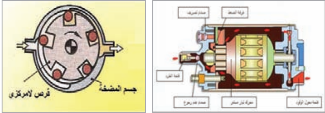
شكل (10): تركيب مضخة الوقود اللامركزية
