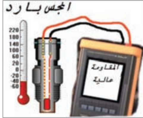
شكل (5): مبدأ عمل مجسّ حرارة الهواء
