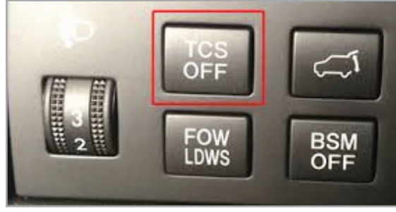
الشكل (16): مفتاح إبطال تفعيل نظام التحكم بالسحب (الجرّ) (TCS)
