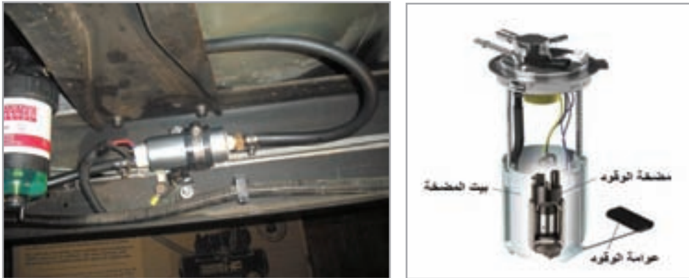
شكل (9): مضخة الوقود الكهربائية
