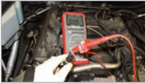
شكل (9): أفحص مجسّ حرارة المحرك
