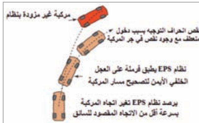
شكل (20): تأثير تعديّ انحراف التوجيه لسيارة على المركبة
