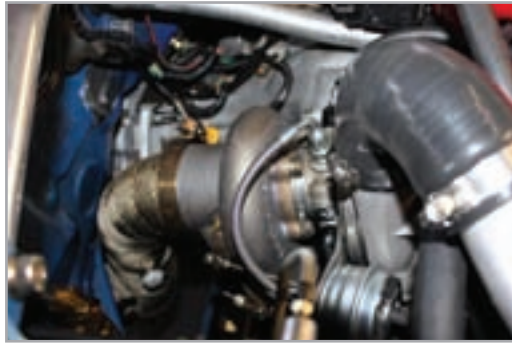
شكل (11): شاحن الهواء الجبري (التيربو)
