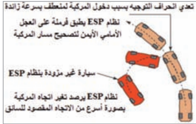
الشكل (19): تأثير تعديّ انحراف التوجيه لسيارة على المركبة
