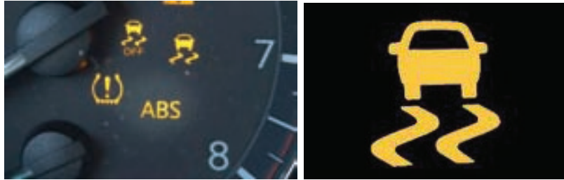
شكل (15): لمبة تحذير نظام التحكم بالسحب (الجرّ (TCS)
